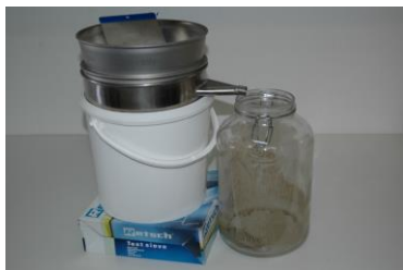
Figure 8 : Système de tamisage pour isoler la fraction < 63 \mu\text{m} (Photo : canton de Berne).
